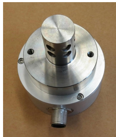
Bild 6: Befestigungsbohrungen für Sensor A19-S
