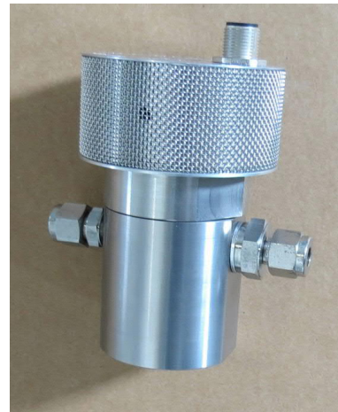
Bild 5: Sensor in Messkammer eingebaut
