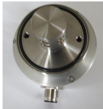
Bild 6: Befestigungsbohrungen für Sensor A19-S
