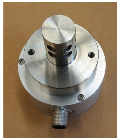
Bild 6: Befestigungsbohrungen für Sensor A19-S
