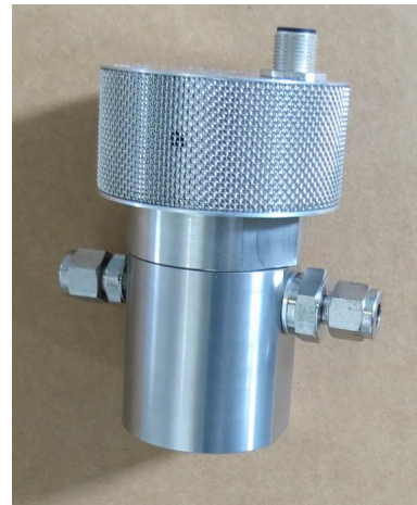
Bild 5: Sensor in Messkammer eingebaut
