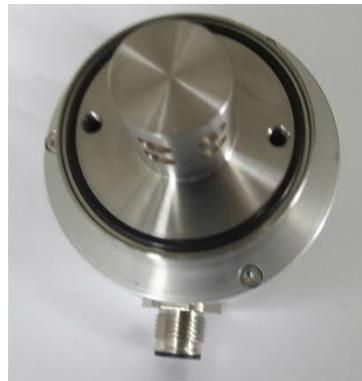
**Bild 6: Befestigungsbohrungen für Sensor A19-S**
