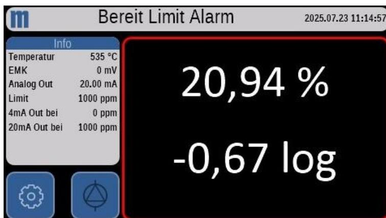
Über die Infozeile wird bei eingeschalteter Messgaspumpe über einen zu geringen Durchfluss informiert. **Anmerkung:** Bei ausgeschalteter Messgaspumpe findet keine Durchfluss-Überwachung statt. Der Messwert wird unabhängig von Alarmen angezeigt.
